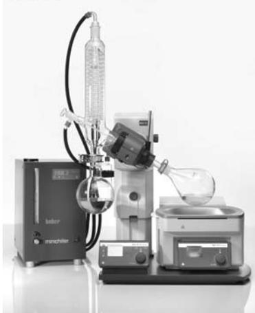
**Le refroidissement d'évaporateurs rotatifs est l'une des applications caractéristiques des refroidisseurs à circulation**
